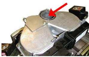
Figura 13 Escorvamento das bombas de sucção (iMeter)
