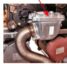
Figura 25 Filtro de entrada – carcaça do filtro grande
