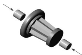
Figure 24 Montage des aimants
