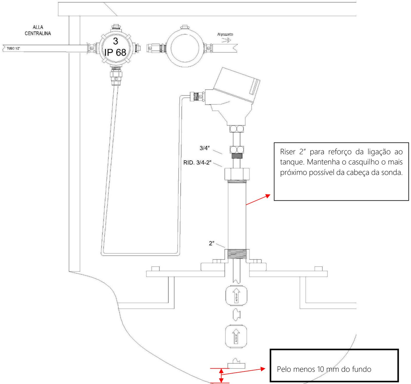
**IMPORTANTE:** se a sonda for instalada sem deixar pelo menos 10mm do fundo do tanque, qualquer deformação do tanque poderá causar danos na sonda.
